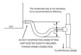
Fig. 4-1 DRAIN LINE INSTALLATION
