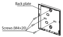
Fig. 5 — Fasten Back Plate
